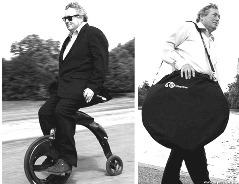
Sensation écolo au Salon du deux-roues, en octobre à Cologne, le Yike Bike est un véhicule électrique pliable, idéal pour les déplacements urbains. L'engin, imaginé par le Néo-Zélandais Grant Ryan, est en fibre de carbone. Il pèse 10 kg et peut rouler jusqu'à 25 km/h sur une dizaine de kilomètres. Sa batterie se recharge sur le secteur en 40 min.
